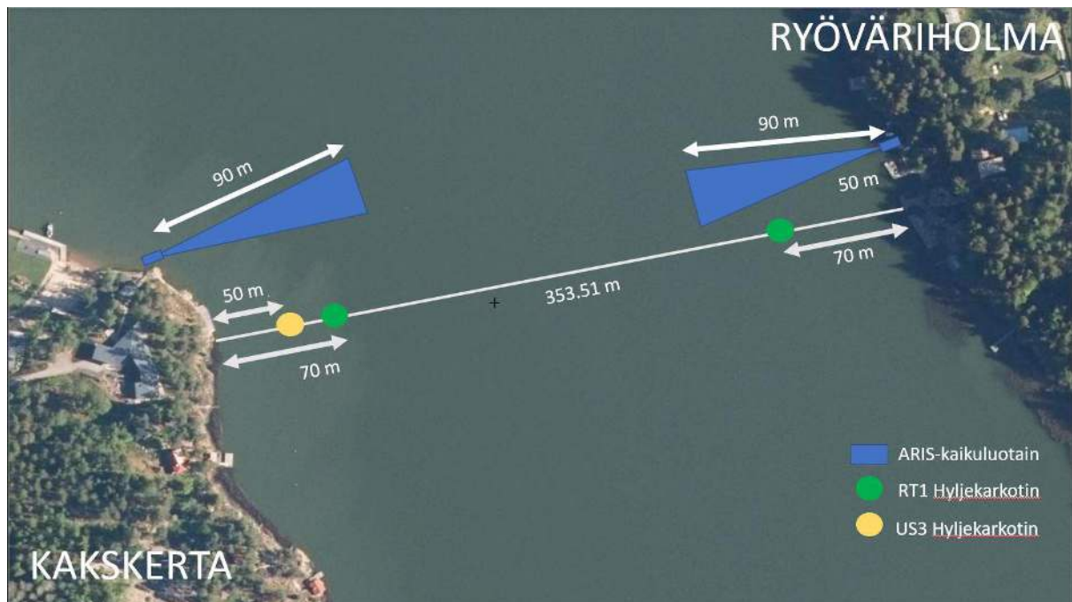
Kuva 1. Kaikuluotaimet asennettiin yksi salmen kummallekin rannalle, hyljekarkottimien toimintasäteen sisälle.
