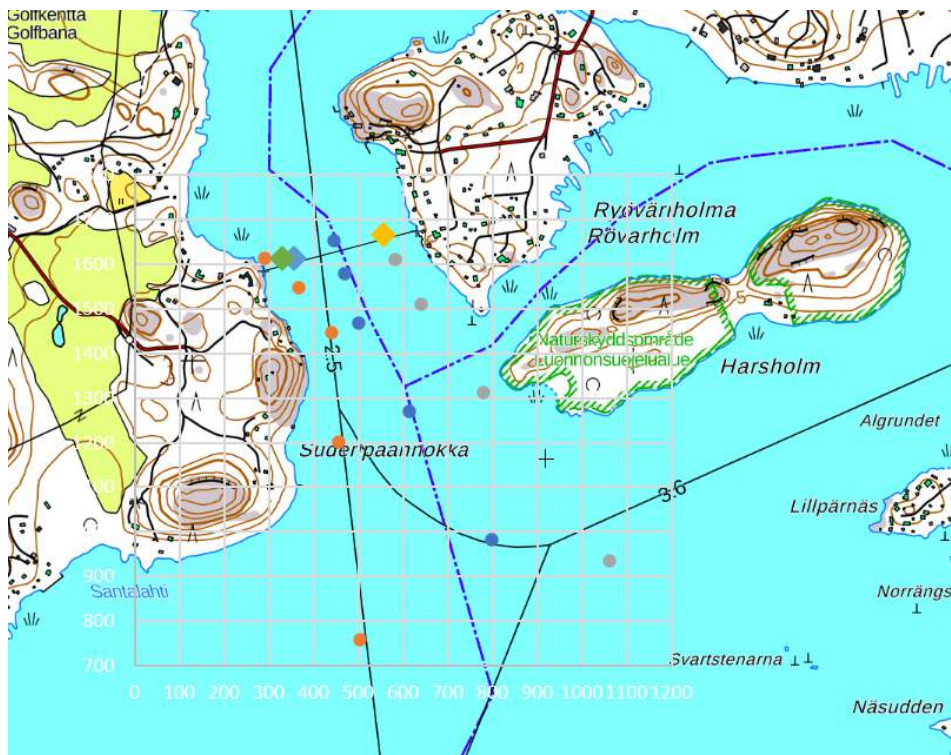
Kuva 1.2. Karkottimien paikat merkattu pystyneliöillä (RT1 - sininen ja keltainen, US3 - vihreä) ja mittauspisteet ympyröillä (Siniset ympyrät = mittauslinja 1, punaiset ympyrät = mittauslinja 2, harmaat ympyrät = mittauslinja 3).
