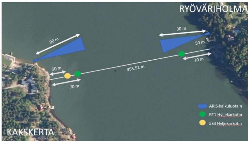
Kuva 1. Koejärjestely syksyn 2021 pilottitutkimuksessa Rönkäholman salmessa. Salmen toisessa rannassa oli RT-1 ja US-3 karkotin, ja toisessa rannassa vain RT-1 karkotin. Lisäksi kummallakin rannalla oli ARIS-luotaimet (siniset keilat kuvaavat luotauksella katettua aluetta).
