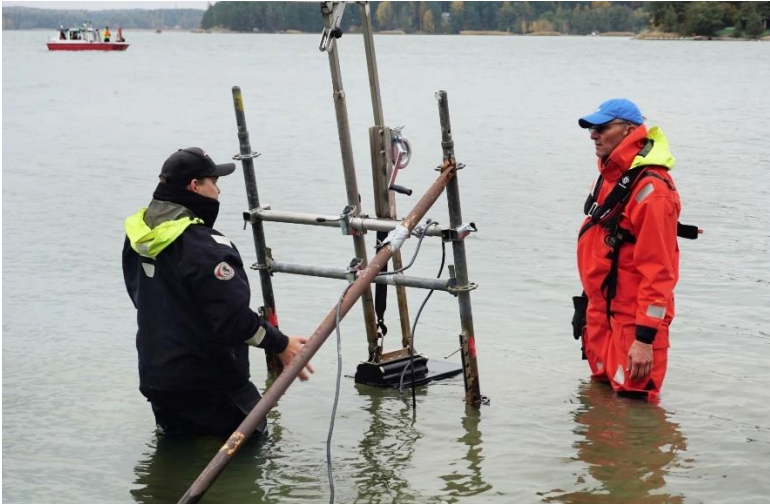
Kuva 3. Putkikehikkoon kiinnitetyt erilliset ARIS-luotaimet asennettiin salmen kummallekin rannalle. Rövarholman salmessa ei ollut esteitä kaikuluotainpulssien edessä, joten kuvasta saatiin hyvänlaatuista.
